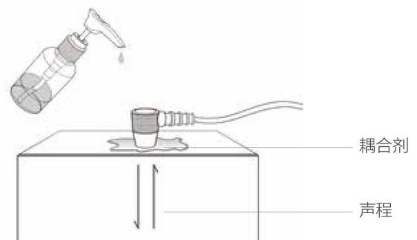
为确保探头正常工作,需使用耦合剂以隔绝探头表面与待测工件表面间的空气,这种液体用于探头及工件间的耦合,称之为耦合剂。
